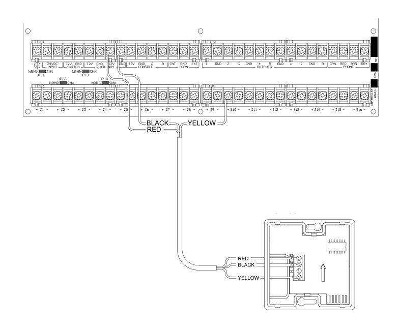
FIGURE 1 – MODEL 31A00-7 CONNECTIONS
