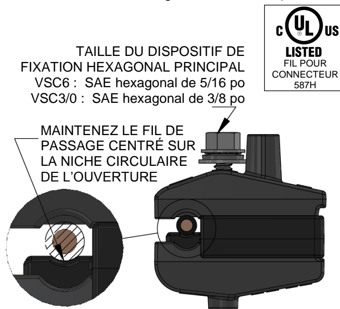
FIGURE 8 : INSÉREZ LE FIL DE PASSAGE ET CENTREZ-LE SUR LA NICHE CIRCULAIRE. SERREZ LE BOULON HEXAGONAL JUSQU'À CE QUE LE COUPLE REQUIS SOIT ATTEINT ET MAINTENU PENDANT 5 SECONDES
